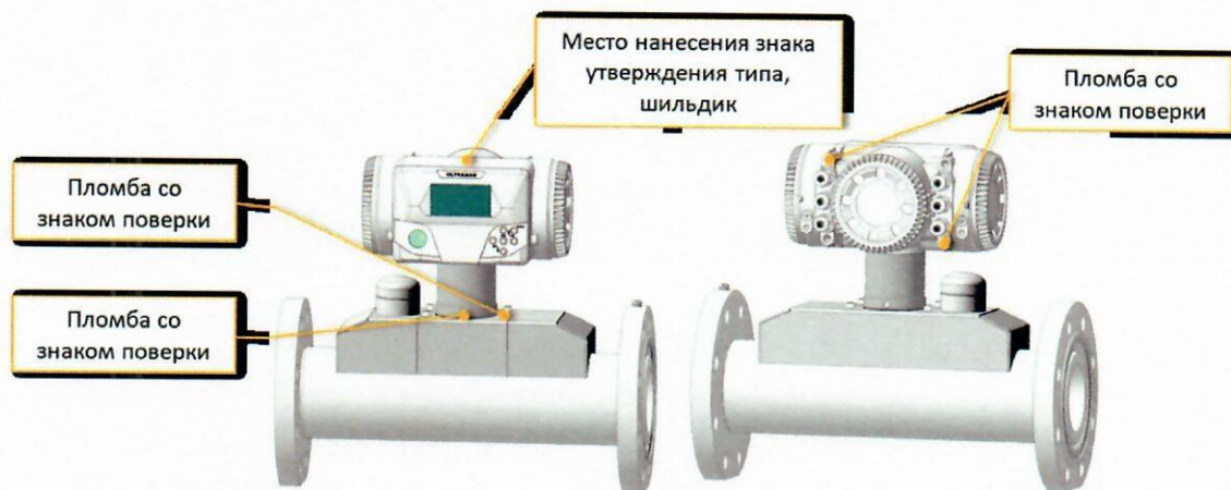
Рисунок 4 – Схема пломбировки комплекса с муфтовым присоединением (базовый ИВБ), указание места нанесения знака утверждения типа, расположение шильдика
